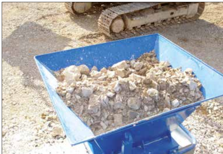
Încărcarea completă a buncărului. Posibilă doar dacă materialul nu este foarte dur și are dimensiuni medii.
