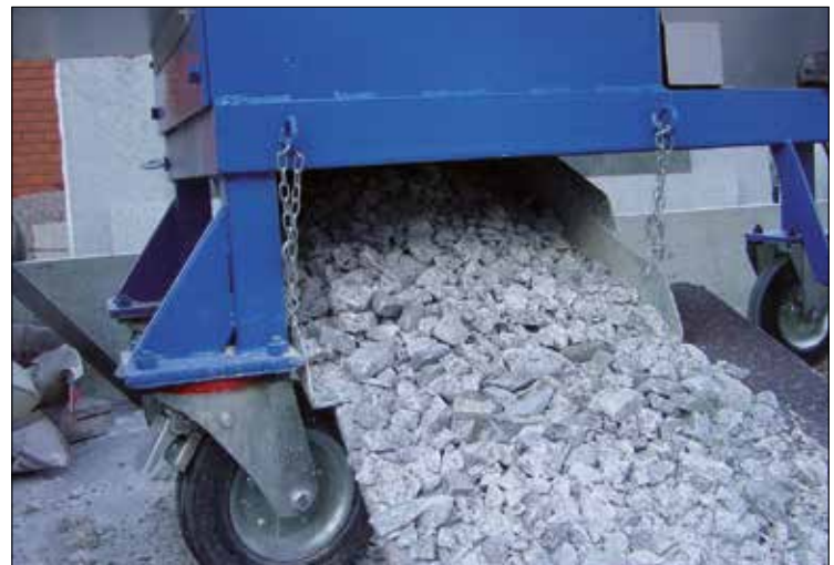
Ieșirea materialului din buncărul de evacuare.
