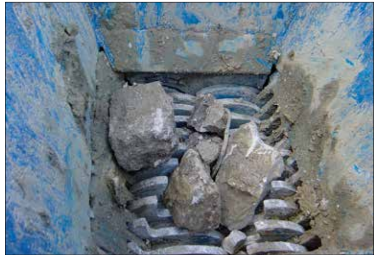
Doi arbori rotativi cu cuțite din oțel special, în timpul funcționării.
