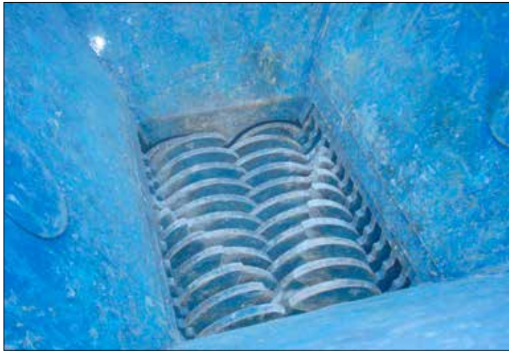
Doi arbori rotativi echipați cu cuțite din oțel special.
